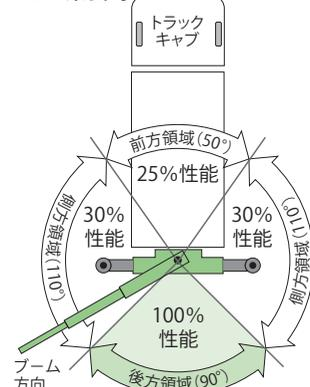
クレーンのつり上げ性能は、クレーンの各種条件により大きく変化します。クレーン作業は十分な注意のもと、安全作業を心掛けてください。
