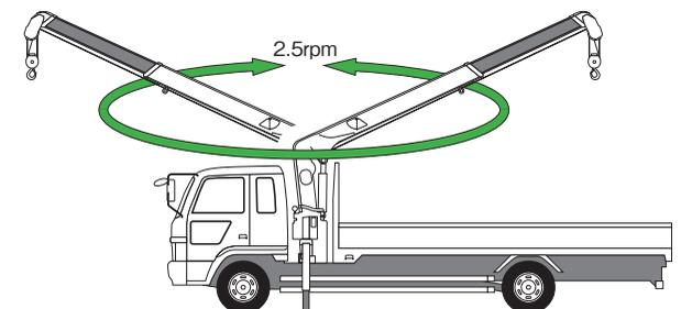
クレーンで荷をつり上げることができる範囲を示した図。作業範囲図上では、実際の作業時に生じるブームのたわみは含まれていません。
