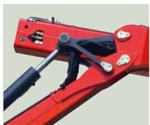
長尺3段式アウトターブームにリンケージ・システムを採用。広い作業領域と鳥居際までとどく深いフトコロ作業を実現するとともに、吊上げ性能や起伏速度の変化も少なく、安定した作業を可能にします。
