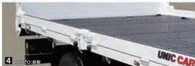
鉄製／アルミ製2分割 [H100mm×幅50mm]
