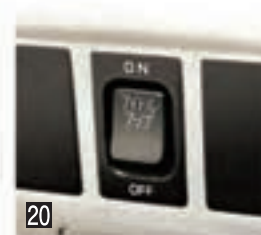
アイドルアップ装置 運転席内のスイッチをONにして荷台・ウインチ操作を行うと、自動的にアイドリングがアップします。 *UC-35EGシリーズ、UC-28EGは4段階のアイドルアップ機能付ラジコンに変更になります。写真のスイッチは付きません。
