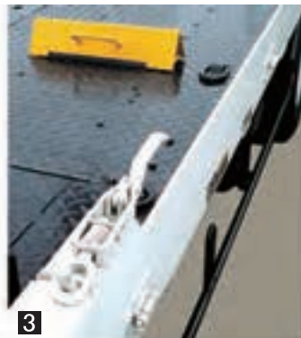
鉄製フラットバー [H100mm×幅9mm]
