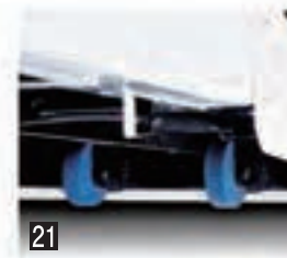
接地ローラー 樹脂製のローラーにより、スライド時の荷台後端部摩擦および騒音を防ぎ、スムーズな作業が行えます。 *機種により取り付けできないことがあります。
