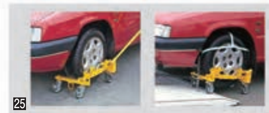
キャスタージャッキ キャスタージャッキはシンプル構造で取扱いがとても簡単!事故や故障等で自走不能となった車両の車輪をキャスタージャッキにて固定。その後はウインチで引上げるだけでOK。事故車両等の積み込み作業をスピーディーにこなす最適なオプションです。 *荷台内エキスパンドメタルおよび埋め込み式固ばく装置との同時装着はできません。 *全幅編鋼板(中心部エキスパンド・スチール製/1,150mm)の専用リヤゲートおよび荷台、ウインチ引上金具、収納箱がセットになります。 *キャスタージャッキ1台あたりの荷重は400kg以内(両輪で800kg)を厳守してください。また、タイヤ外径はφ500mm〜φ700mm以内です。 *スペースの都合により収納箱が取り付けできない場合があります。
