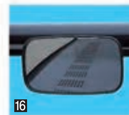
荷台確認ミラー[追加] 鳥居と積載車との間隔を確認できるため、安全な作業が行えます。 *標準装備(1ヶ)されていますが、追加で取り付けることができます。(UC-21Wは標準装備(2ヶ)です。)
