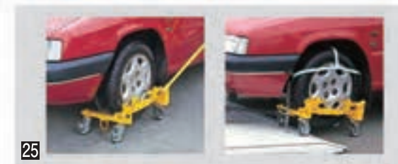
キャスタージャッキ キャスタージャッキはシンプル構造で取扱いがとても簡単!事故や故障等で自走不能となった車両の車輪をキャスタージャッキにて固定。その後はウインチで引上げるだけでOK。事故車両等の積み込み作業をスピーディーにこなす最適なオプションです。 *荷台内エキスパンドメタルおよび埋め込み式固ばく装置との同時装着はできません。 *全幅編鋼板(中心部エキスパンド・スチール製/1,150mm)の専用リヤゲートおよび荷台、ウインチ引上金具、収納箱がセットになります。 *キャスタージャッキ1台あたりの荷重は400kg以内(両輪で800kg)を厳守してください。また、タイヤ外径はφ500mm〜φ700mm以内です。 *スペースの都合により収納箱が取り付けできない場合があります。
