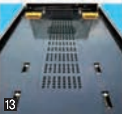
埋め込み式 固ばく装置 ワイヤーロープを埋め込み式にしたことにより下部から簡単に固定できます。ローダウン車におすすめです。
