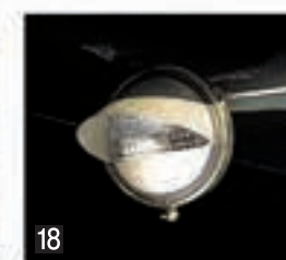
タイヤ灯 夜間や悪天候下などでの作業時にトラックの後輪周辺を照らします。左右各1ヶずつ装着されます。 *UC-02Eシリーズ、UC-35E、UC-28EGはLEDタイプ。 *UC-21Wは形状が異なります。
