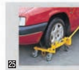
キャスタージャッキ キャスタージャッキはシンプル構造で取扱いがとても簡単!事故や故障等で自走不能となった車両の車輪をキャスタージャッキにて固定。その後はウインチで引上げるだけでOK。事故車両等の積み込み作業をスピーディーにこなす最適なオプションです。 *荷台内エキスパンドメタルおよび埋め込み式固ばく装置との同時装着はできません。 *全幅編鋼板(中心部エキスパンド・スチール製/1,150mm)の専用リヤゲートおよび荷台、ウインチ引上金具、収納箱がセットになります。 *キャスタージャッキ1台あたりの荷重は400kg以内(両輪で800kg)を厳守してください。また、タイヤ外径はφ500mm〜φ700mm以内です。 *スペースの都合により収納箱が取り付けできない場合があります。
