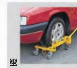
キャスタージャッキ キャスタージャッキはシンプル構造で取扱いがとても簡単!事故や故障等で自走不能となった車両の車輪をキャスタージャッキにて固定。その後はウインチで引上げるだけでOK。事故車両等の積み込み作業をスピーディーにこなす最適なオプションです。
