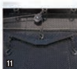
ウインチ引上げ金具 自走できないクルマなどをウインチ(中央牽引フック位置)で引き上げる時、無理な引き上げ方向にならず、鳥居付近まで引き上げることができます。
