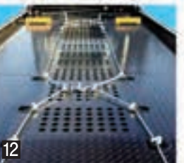
固ばく装置 荷台前部に装備された荷締機により、積載車を下部から簡単に固定できます。
