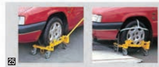
キャスタージャッキ 簡易な構造で取扱いが簡単!事故や故障等で自走不能となった車両の車輪をキャスタージャッキにて固定。その後はウインチで引上げるだけでOK。事故車両等の積み込み作業をスピーディーにこなす最適なオプションです。 *荷台内エキスパンドメタルおよび埋め込み式固ばく装置との同時装着はできません。 *全幅編鋼板(中心部エキスパンド・スチール製/1,150mm)の専用リヤゲートおよび荷台、ウインチ引上金具、収納箱がセットになります。 *キャスタージャッキ1台あたりの荷重は400kg以内(両輪で800kg)を厳守してください。また、タイヤ外径はφ500mm〜φ700mm以内です。 *スペースの都合により収納箱が取り付けできない場合があります。
