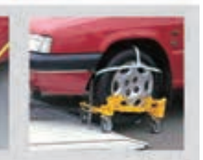
キャスタージャッキ キャスタージャッキはシンプル構造で取扱いがとても簡単!事故や故障等で自走不能となった車両の車輪をキャスタージャッキにて固定。その後はウインチで引上げるだけでOK。事故車両等の積み込み作業をスピーディーにこなす最適なオプションです。
