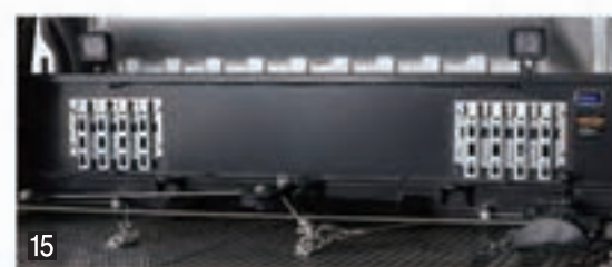
タイアラッシング装置収納スペース 鳥居腰板部にタイアラッシング金具の収納スペースを設置可能です。
