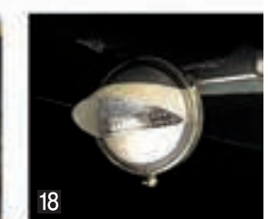
タイヤ灯 夜間や悪天候下などでの作業時にトラックの後輪周辺を照らします。左右各1ヶずつ装着されます。 *UC-02Eシリーズ、UC-35E、UC-28EGはLEDタイプ。 *UC-21Wは形状が異なります。
