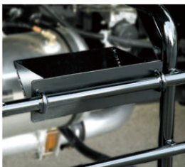
樹脂製車輪止め収納スペース
