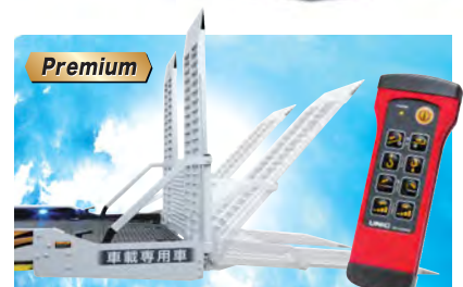
Premium ラジコン操作でロック解除も可能な 全自動油圧開閉式リヤゲート
