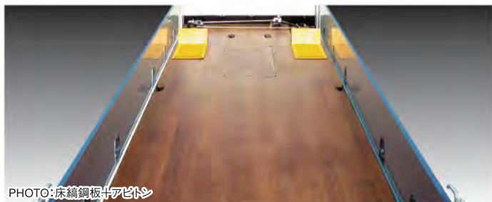
PHOTO:床縞鋼板+アビトン
