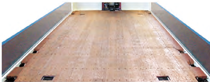
PHOTO: 床縞鋼板+アピトン張り
