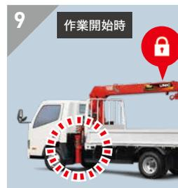
**9 ブーム・アウトリガインターロック装置 (ブーム車幅規制付) 特許**
