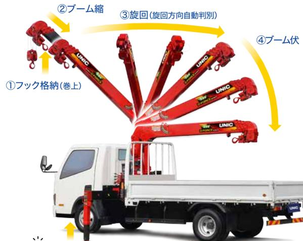
**ポイント** オプションのアウトリガラジコンを装着すると縦アウトリガの縮も格納します!
